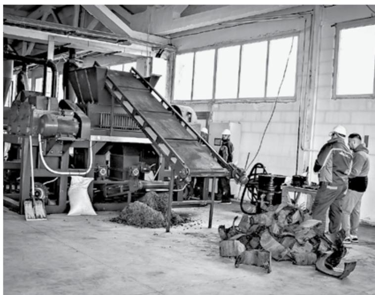
Одна линия пропускает тонну сырья в час.
