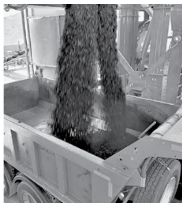
Отгрузка асфальтобетонной смеси для ремонта дорог.
