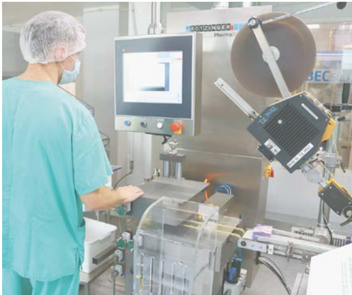
Алтайские фармацевтические предприятия используют в основном импортное оборудование. Вот на этом идет маркировка лекарства.
