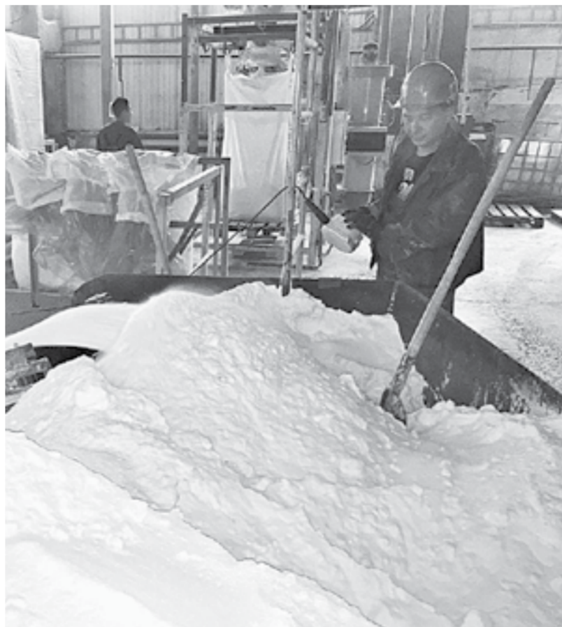
За смену гранулируется вагон кристаллического сульфата аммония.
