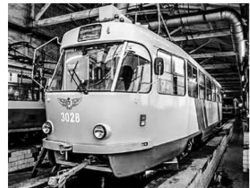
В вагоне полностью заменены внутренняя обшивка салона, пассажирские сиденья, электрооборудование. Также отремонтированы ходовая часть и кузов. Такое обновление позволяет продлить срок эксплуатации еще на пятнадцать лет.
