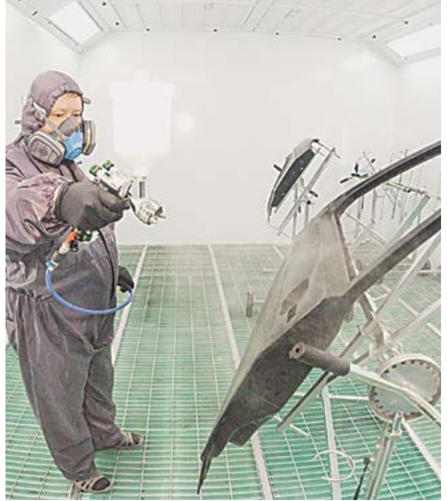
В мастерской установлена большая окрасочно-сушильная камера.
