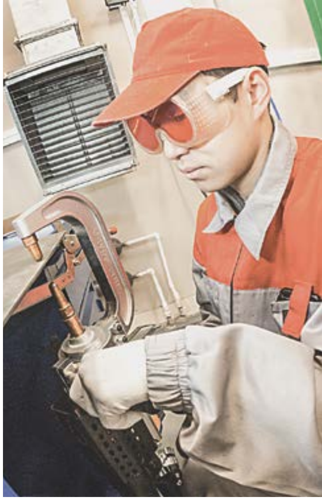
Так выполняется двусторонняя точечная сварка.
