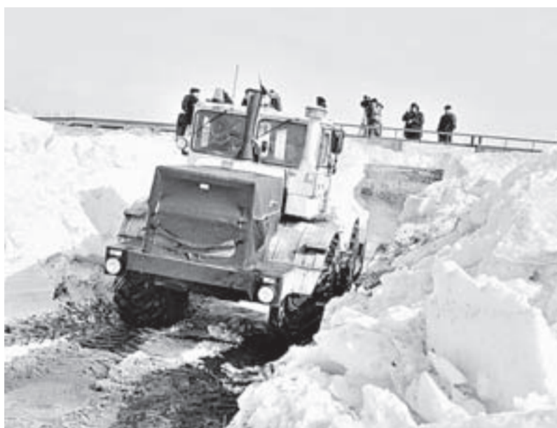
«Кировец» пробивает в снегу траншею для прохода талой воды.
