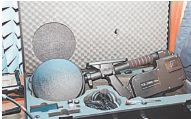
Нелинейный локатор, предназначенный для поиска жучков.
