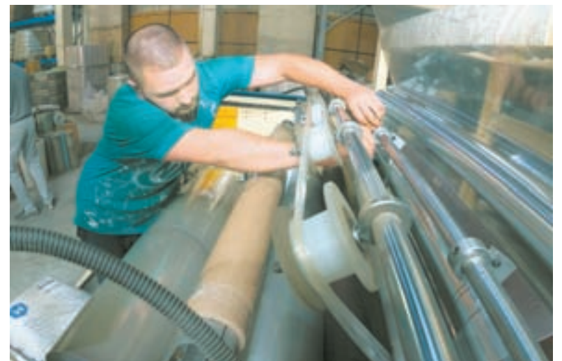
Идет настройка вальцов, на которых получают пленку.
