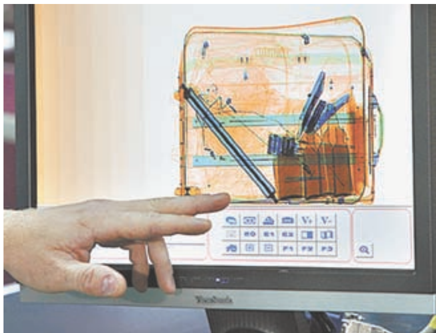
Чем предмет плотнее, тем темнее его цвет на экране.
