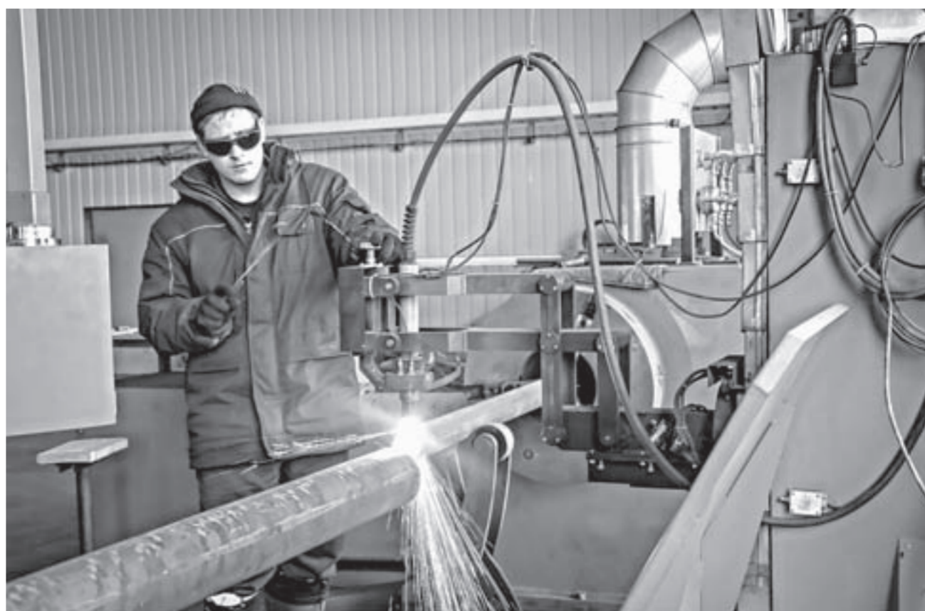
Оператор ЧПУ плазменной резки Антон Черемнов торцует трубу.
