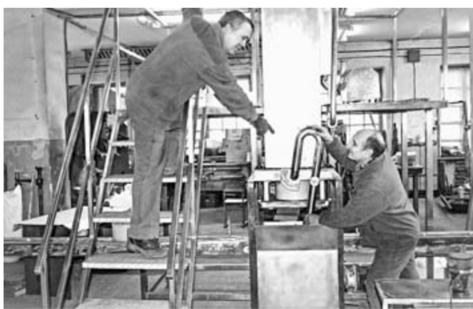
Отладка дозатора сырного зерна.
