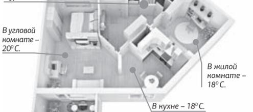
Температура замеряется в 1 метре от наружной стены и на высоте 1,5 метра от пола в течение 10 минут.
