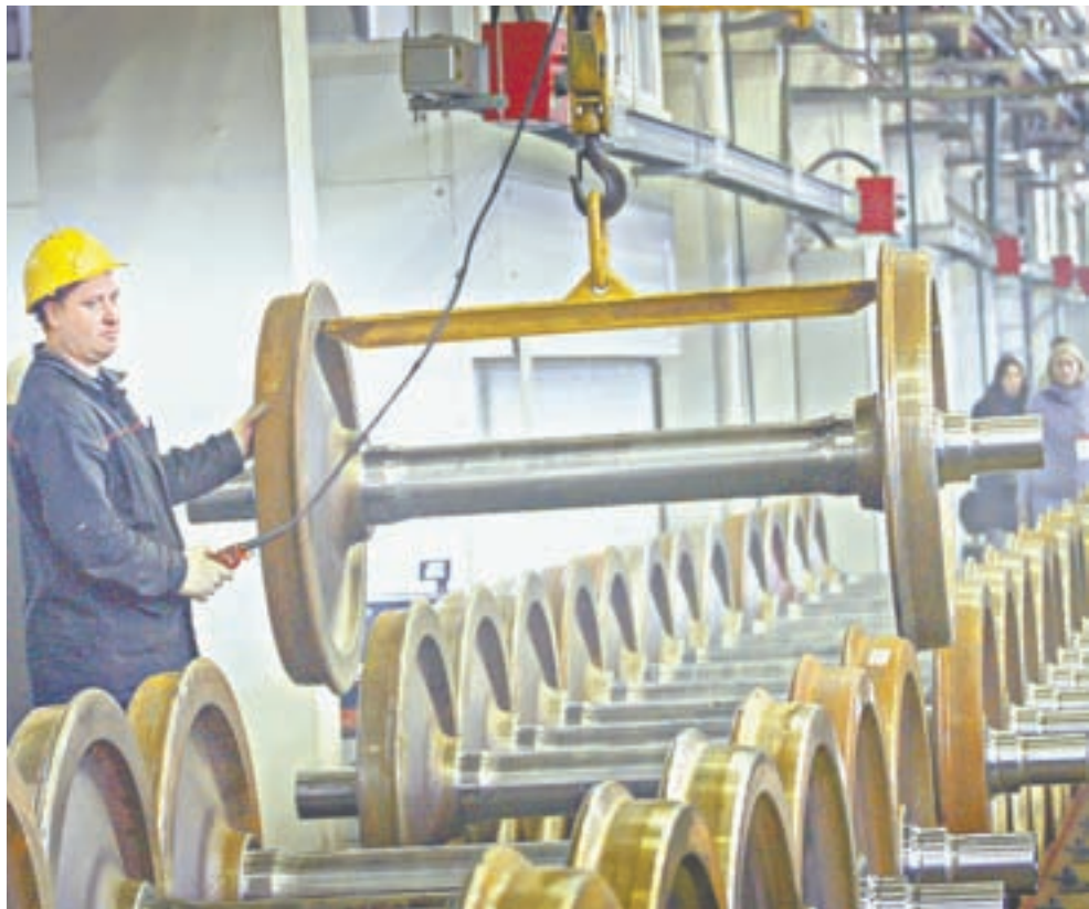
Обработанные роботами колесные пары имеют идеальную геометрию.
