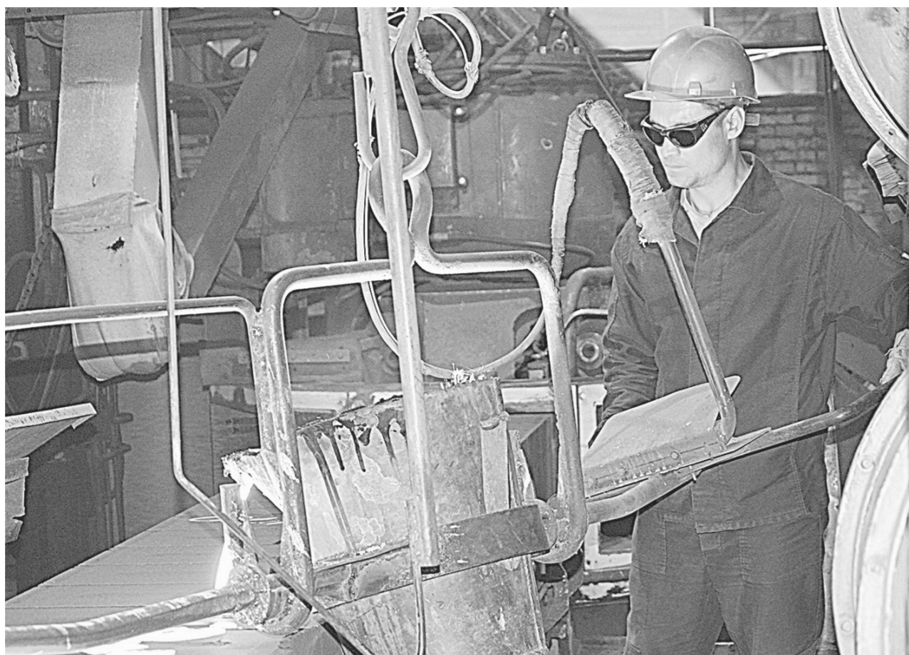
Процесс заливки чугуна.
