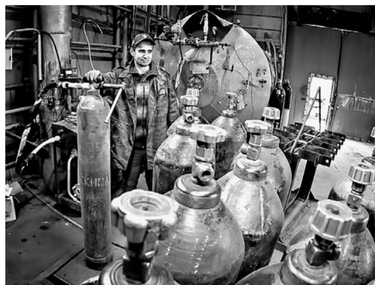
Баллоны с углекислотой наполняет Эдуард Салахутдинов: «Поставил на весы, налил 25 ниллограммов — и готово. Главное — не обморозиться».
