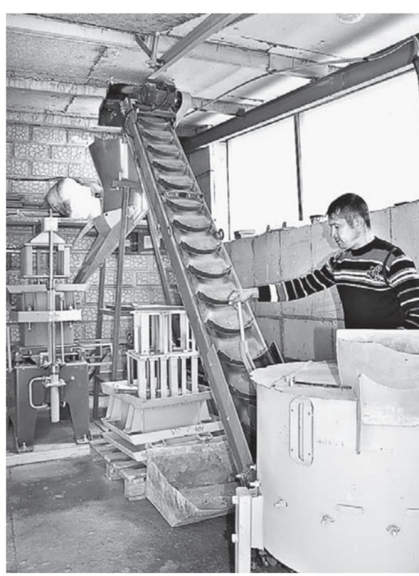
Оборудование по вибропрессованию блоков позволило заметно увеличить производительность труда.
