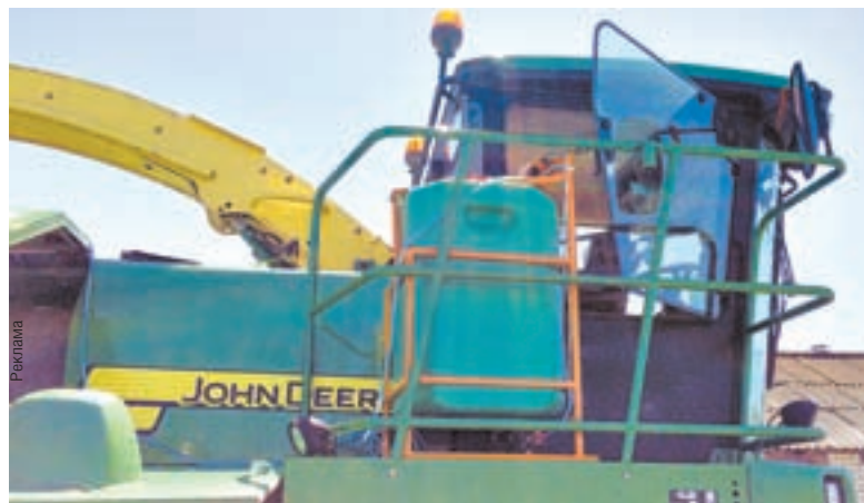
УДР2М – устройство, которое применяется для внесения консервантов.
