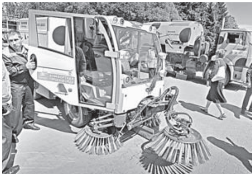
Подметально-вакуумная машина убирает мусор, моет дорожное полотно, дорожные знаки и ограждения.
