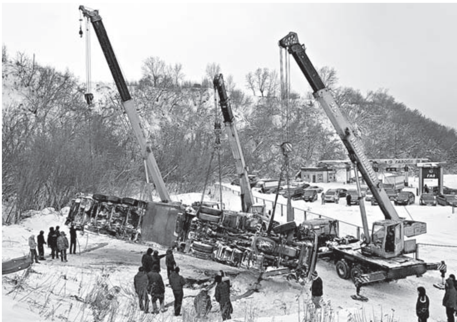
Понадобилось три крана, чтобы поднять многотонную машину.
