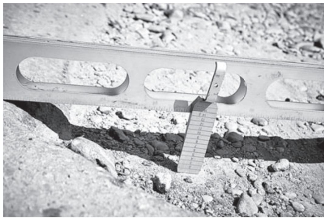
Глубина выбоины на проезжей части — 14 см.
