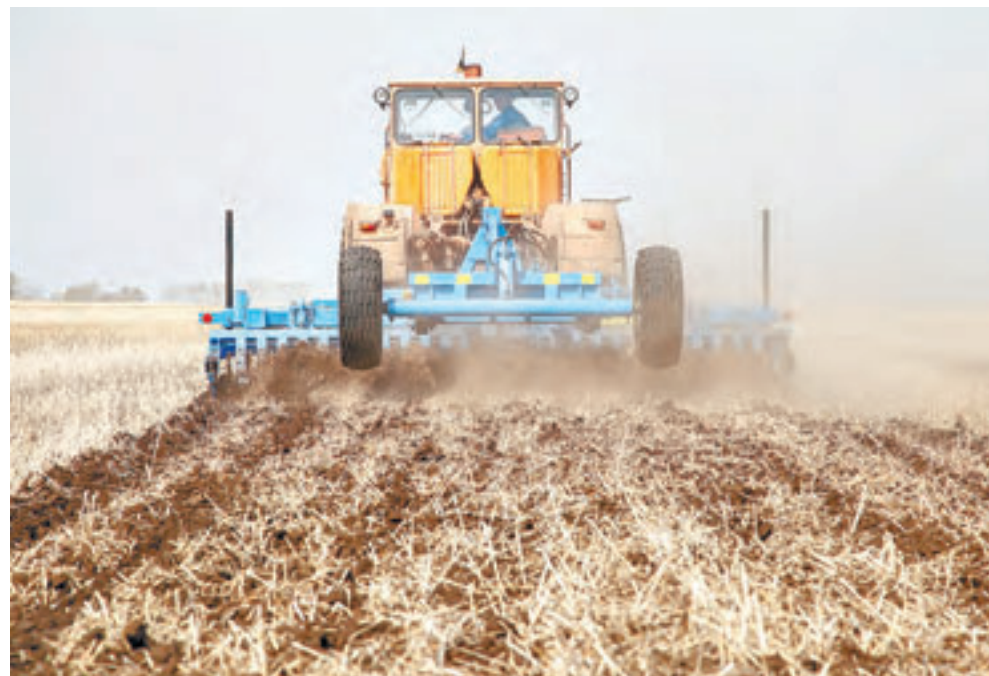
Чизельный плуг ПЧ-6 проходит испытания на Алтайской машиноиспытательной станции.
