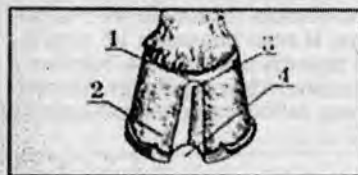
Подготовка к заделке трещины: 1 - поперечный желобок; 2 - продольные желобки; 3 - трещина; 4 - вырезка.
