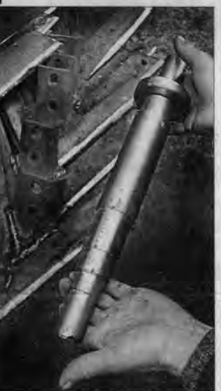
Вал водяного насоса и лапки изготовлены в мастерских хозяйства на подручных материалах. Усиленные запчасти дороги и, что еще печальней, часто плохого качества.
