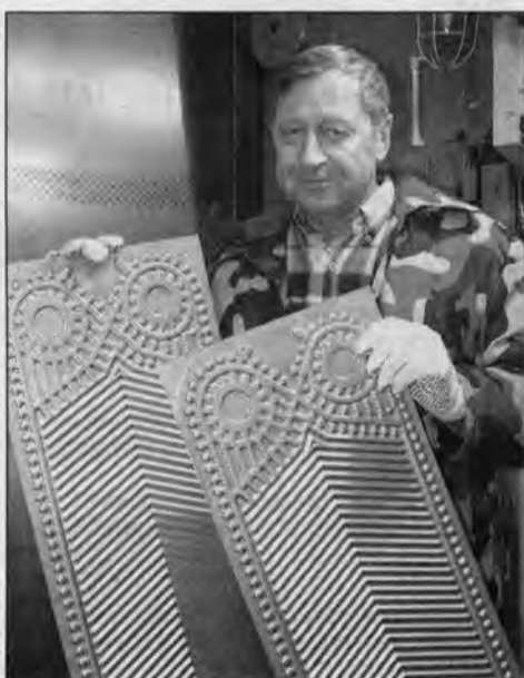
Формовщик Александр Литвинов. Работает, по местной терминологии, в «шалаше»: чтобы будущая пластина теплообменника приобрела правильную форму, рядом с его станком постоянно должна быть температура не менее +20 градусов: «Главное, чтобы металл был теплым, остальное приложится».
