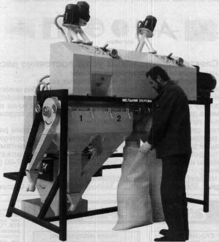
МЕЛЬНИК 100 РОЖЬ в действии (производительность мельницы 100 кг зерна в час, выход 85% муки ржаной обдирной).
