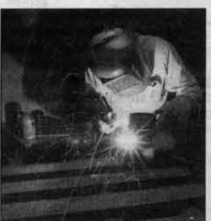
Корпуса свариваются вручную с использованием аргонодуговой и углекислотной сварки.
