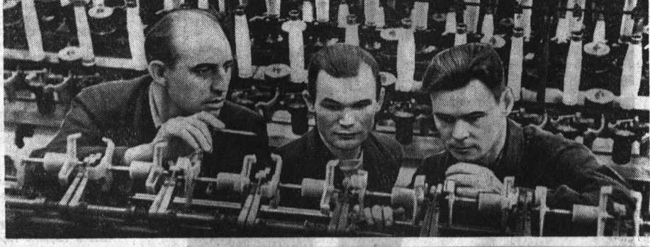
Точарь Константин Ярочкин, слесарь Петр Ершов и механик Савелий Ашеулов предложили отплавить крестовины прямо на комбинате, в цехе резки прутков, от отходов напрана. Они сами сделали пресс-форму. Теперь крестовины делаются из напрана и обходятся комбинату очень дешево. Они не боются и не трутся. Шпек идет только первым сортом. Срок их работы увеличился по сравнению с заграночными с шести месяцев до трех лет. Хороший подарок рабочих Первомаю!
