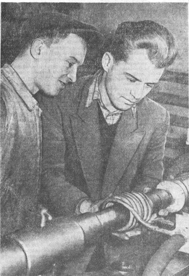
По инициативе инженера Ф. С. Моисаченко в инструментальном цехе Барнаульского вагоноремонтного завода сделано приспособление для металлизации втулок токами высокой частоты. Новшество снижает расходы цветного металла и экономит около девяти тысяч рублей в год.
