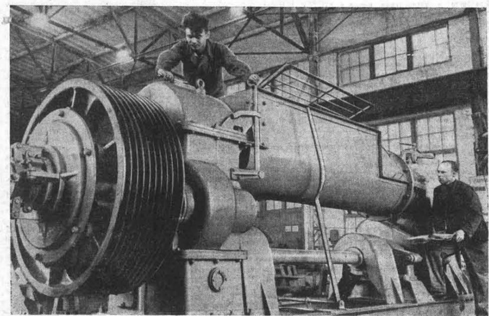
Харьков. На машиностроительном заводе «Красный Октябрь» создан новый пресс СМ-443, предназначенный для изготовления иртышских блоков из пластического прессования. Производительность этой машины и переводе на металл — в три раза больше, чем на обычной. Недавно отгружена первая партия таких машин для предприятий Урала, Московской области, Украины и Кавказа. На снимке: слесари А. С. Денурко (слева) и мастер Н. А. Горбачев за монтажом новой машины. (Фотохроника ТАСС).
